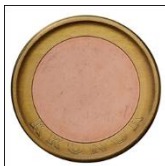
Prototyp till bimetallmynt. Kombination av kopparpläterat stål och Nordic gold.
